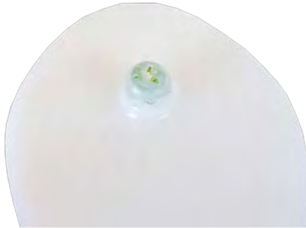
Figure 10: Plastic Accumulation Generated Using an Uninsulated Technovent Figura 10: accumulo di plastica generato dall'uso di un Technovent non isolato.
