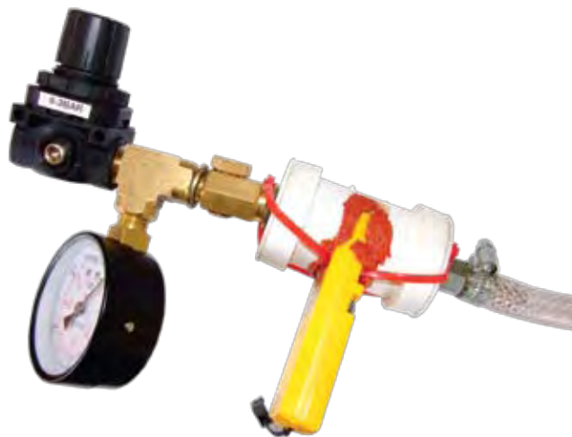
Figure 5: Pressure and Flow Measuring Set Up Figura 5: impianto per misurazione pressione e flusso
